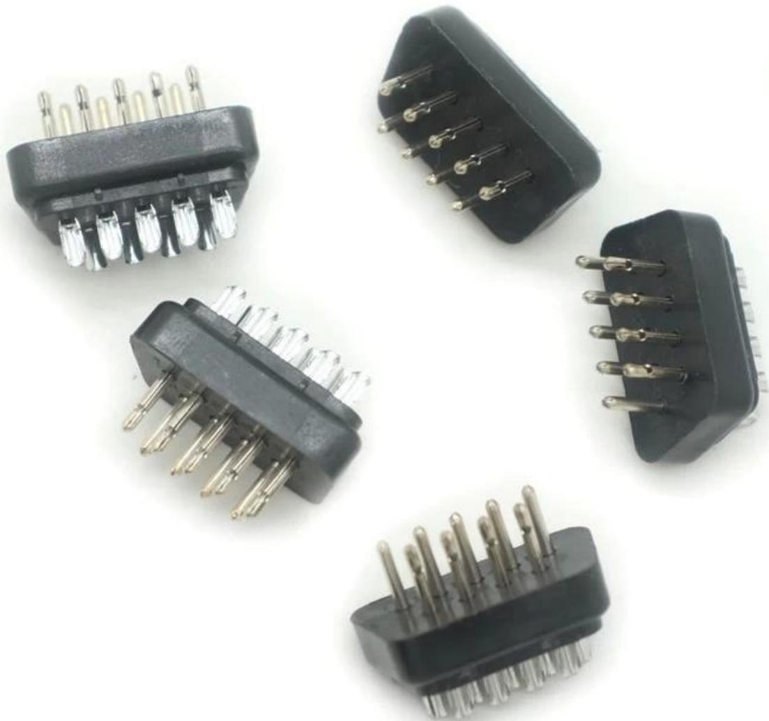
Der schwarze Isolator wird aus hochtemperaturbeständigen Thermoplastik hergestellt und bietet eine hervorragende elektrische Isolierung und strukturelle Stabilität. Dieses Design gewährleistet eine langfristige Zuverlässigkeit sowohl in Industrie- als auch bei medizinischen Anwendungen, wo eine konsistente Leistung von entscheidender Bedeutung ist.
